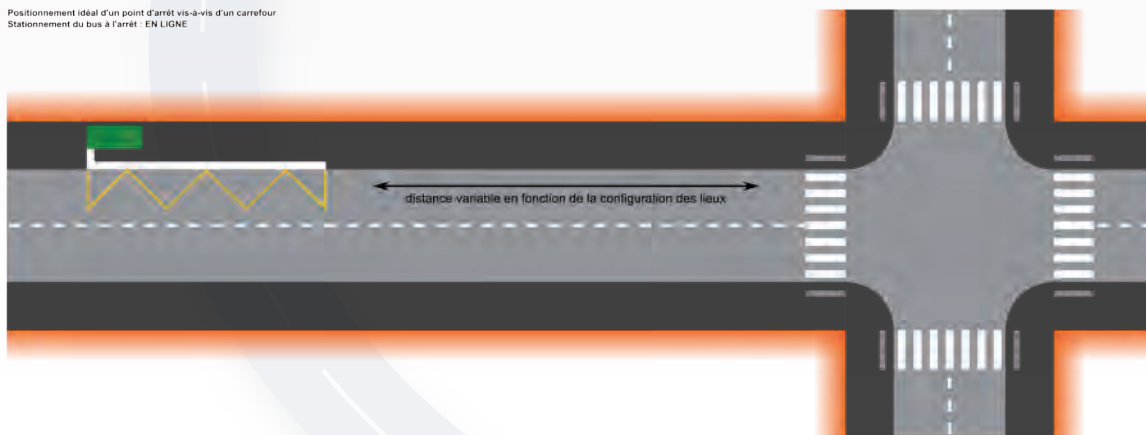
Positionnement idéal d'un point d'arrêt vis-à-vis d'un carrefour Stationnement du bus à l'arrêt : EN LIGNE
